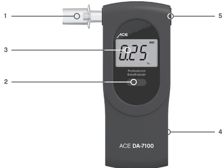
1. Boquilla & La apertura para la fijación de las boquillas
